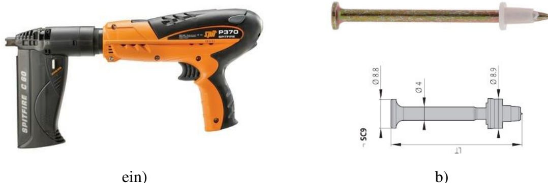
Abbildung 3-3: Befestigungssystem SPIT SC 9-70 mit pulverbetriebenem Setzgerät SPIT P370.
