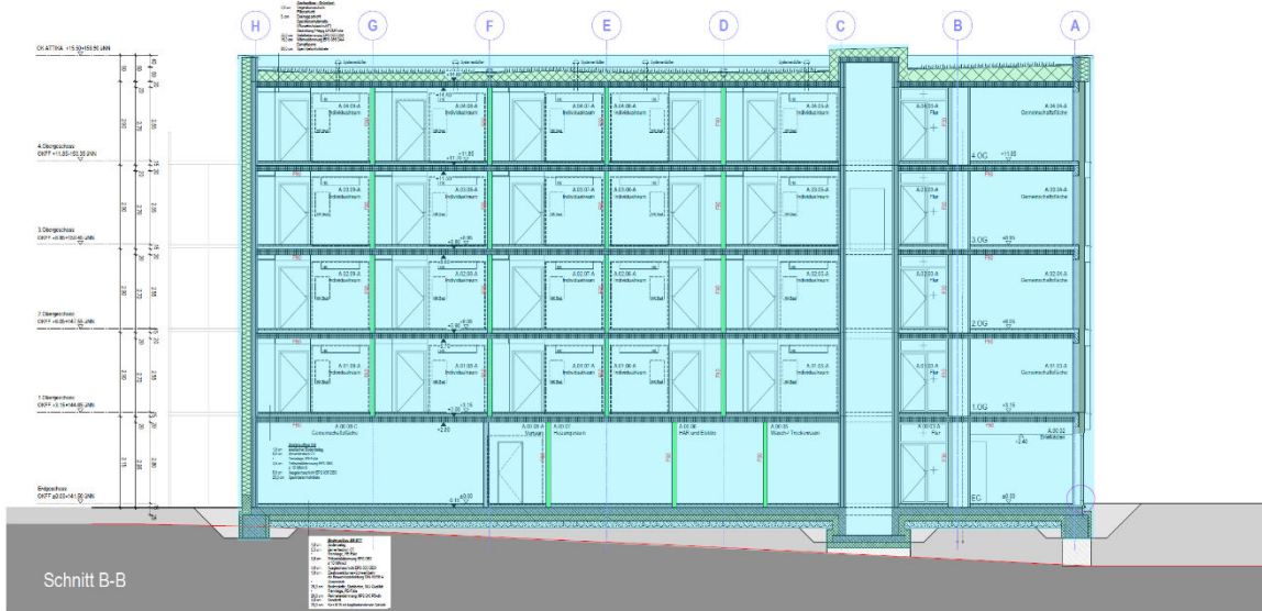
Bild 5-1: Systemgrenzen im Schnitt B-B, Haus A
