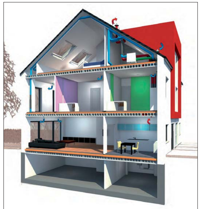
Gebäudeschnitt mit Lüftungsdecken
