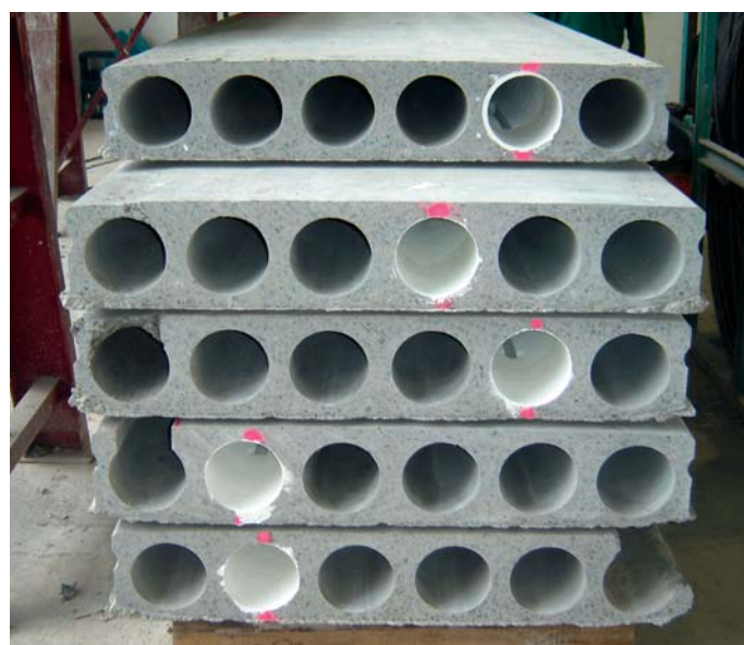
Plattenstapel mit beschichteten Hohlkammern
