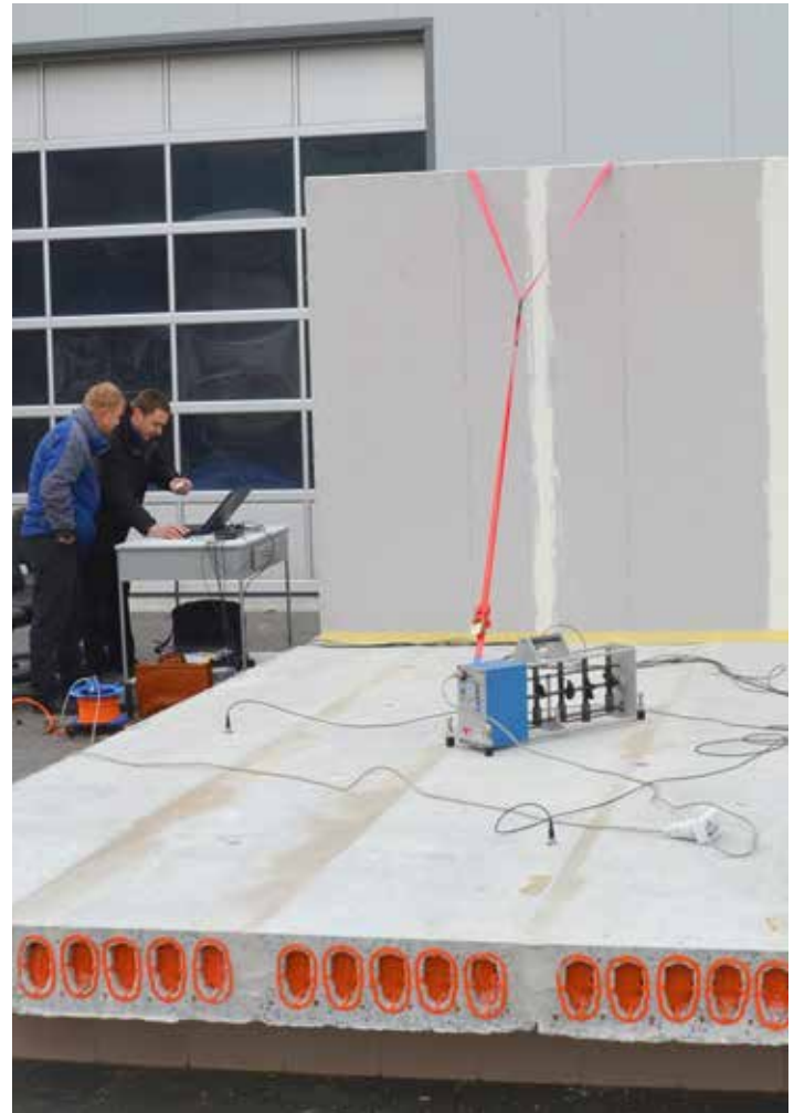
Prüfabbau an der MFPA Leipzig für die Längsschallmessungen an BRESPA ®-Decken.
