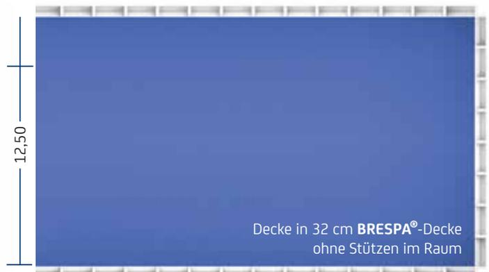
Das Deckensystem mit einer Stützenreihe ist konventionell mit 25 cm starken Betondecken möglich, Betondeckensysteme ohne Mittelstützen sind konventionell in üblichen Dicken nicht ausführbar.
