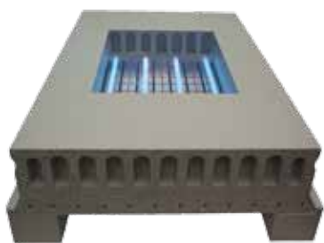
Die Betondecke wird zum Kühlen genutzt
