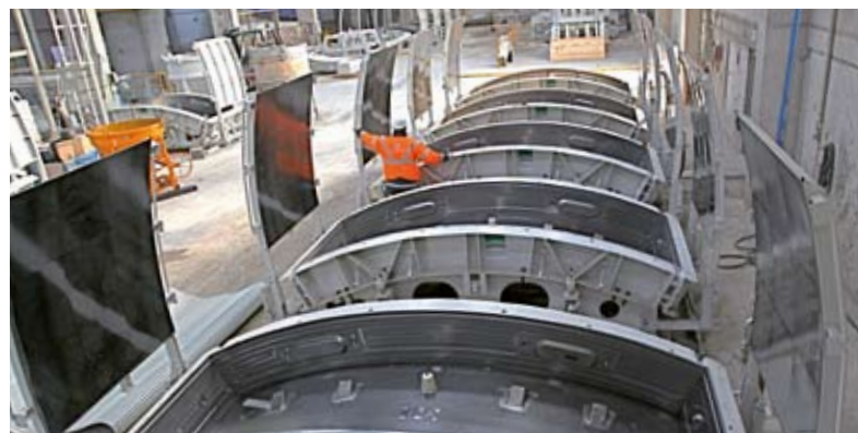
Blick auf die für die Tübbing-Produktion eigens eingerichtete Fertigungsstraße.
