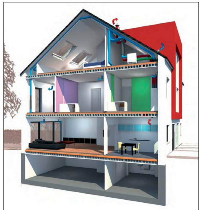
Gebäudeschnitt mit Lüftungsdecken
